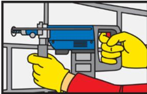
Realice la perforación con un taladro eléctrico, con el diámetro y la profundidad necesarios. El diámetro de la perforación tiene que ajustarse al tamaño del anclaje.
